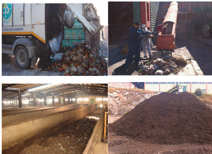
Εικόνα 2: Επεξεργασία προδιαλεγμένων βιοαποβλήτων και παραγόμενο κόμποστ στο ΕΜΑΚ Άνω Λιοσίων
