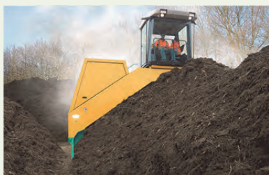
Ανοιχτό σύστημα κομποστοποίησης σε σειράδια με φυσικό αερισμό και μηχανική ανάδευση
