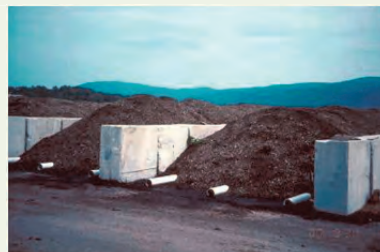
Ανοιχτό σύστημα κομποστοποίησης σε σειράδια με εξαναγκασμένο αερισμό με ή χωρίς μηχανική ανάδευση
